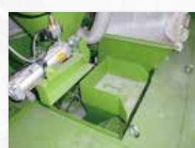
混和材手投入シュート
