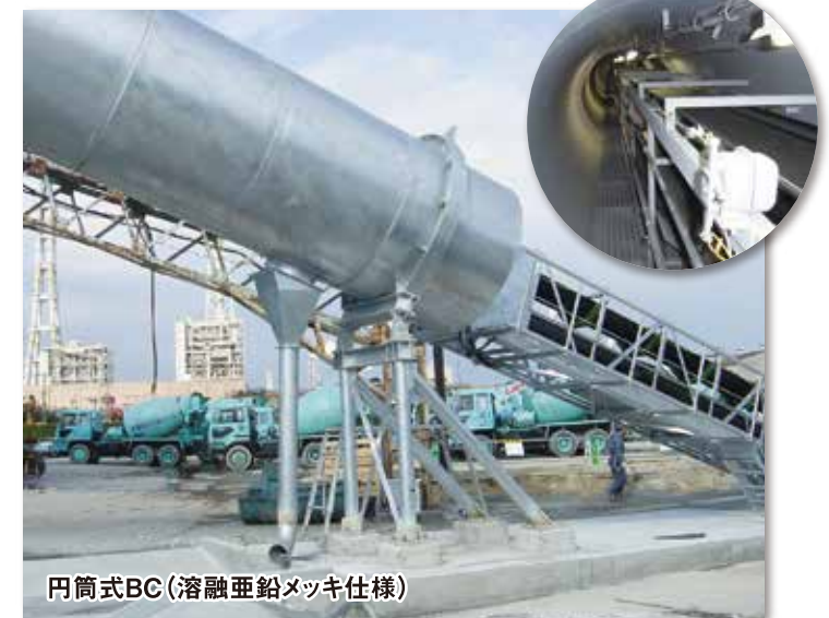
急傾斜BC供給設備
