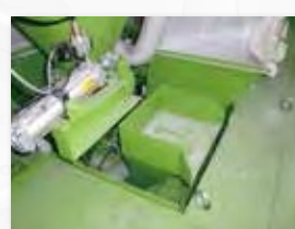
混和材手投入シュート
