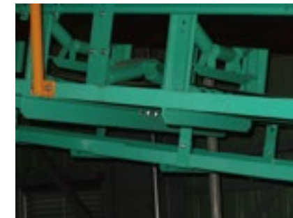
◎蛇行防止装置 リタン側ベルトの蛇行を防止する V型押さえローラ
