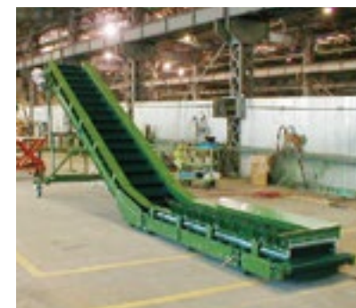
⑦ 廃棄プラスチック搬送コンベヤ
