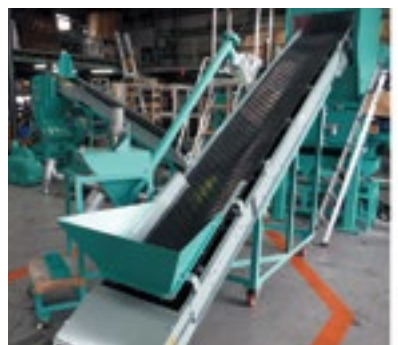
⑦ 廃電線搬送コンベヤ
