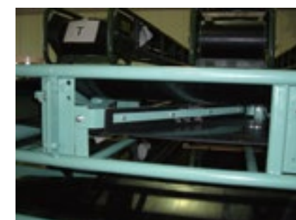
◎正逆運転 ナイフスクレーパを取付 リタン側に取付
