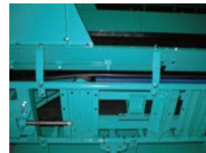
◎インパクトバーを取付
