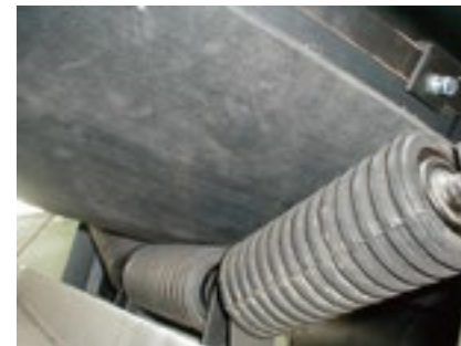
◎衝撃防止 投入部のベルトの衝撃緩和に インパクトローラ(600W以上)
