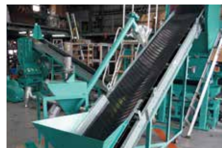
廃電線搬送コンベヤ
