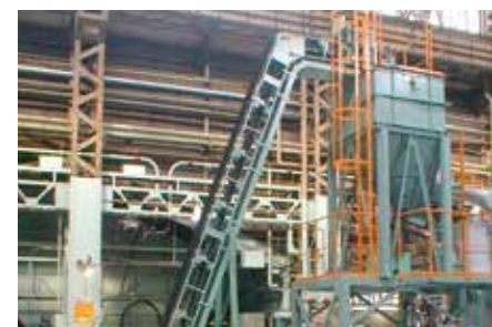
鉛片搬送コンベヤ(急傾斜コンベヤ)
